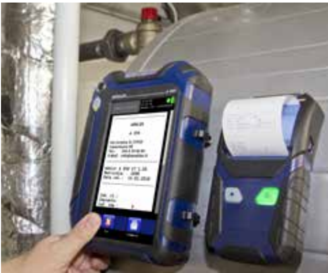
Stampa analisi – tutte le analisi e le verifiche di sicurezza si possono stampare direttamente con la stampante Wöhler TD 100.
