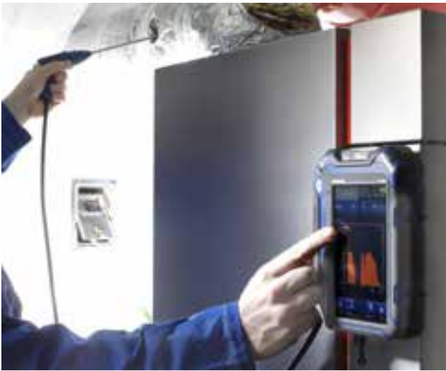
Comodo e chiaro nella rappresentazione – analisi di combustione e regolazione bruciatore semplicemente con il tocco dello schermo.
