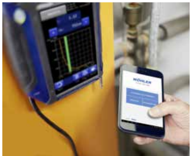
Wöhler A 550 App misura (Android) – permette di comandare l'analizzatore a distanza con uno Smartphone.
