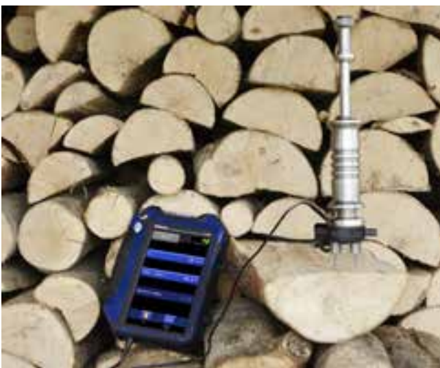
Misura umidità della legna – misura automatica dell'umidità legna con sensore compatto e/o a percussione ed inserimento automatico dei valori.
