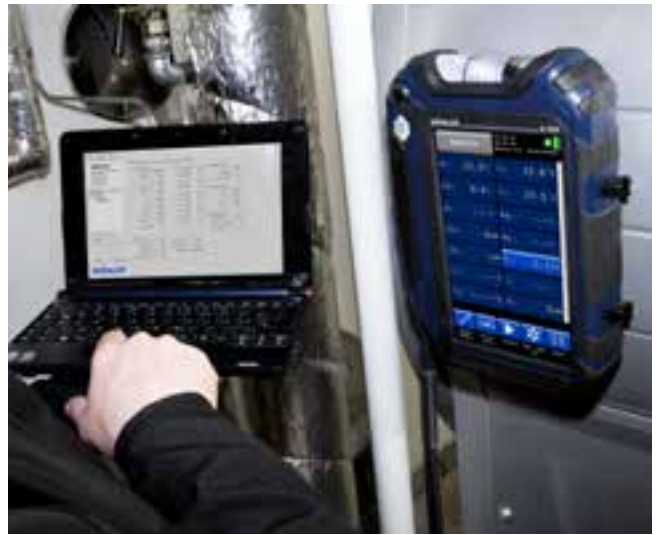
Trasmissione dati – i valori misurati si trasmettono al PC online, via Bluetooth® e USB. L'elaborazione e l'analisi dei dati si effettua comodamente con il programma PC.
