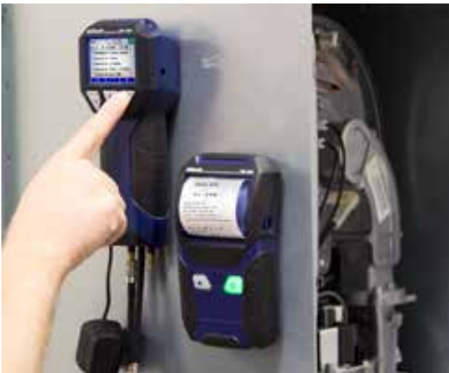
Stampa delle misure e delle prove di tenuta
