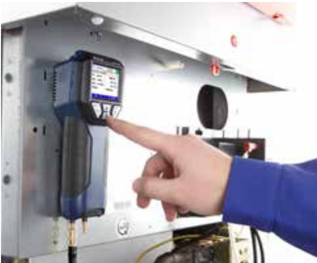
Prova di tenuta UNI 7129 / 11137 con metodo diretto delle dispersioni gas
