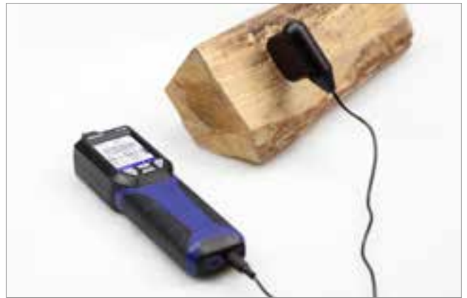
Analisi umidità con Wöhler HF 550 e sonda ad aghi compatta
