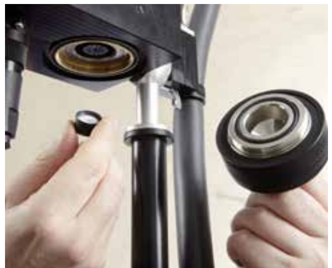
Misura gravimetrica con filtri di misura utilizzabili per più misure e rigenerabili, sarà l'analizzatore a dire quando il filtrino è da cambiare.
