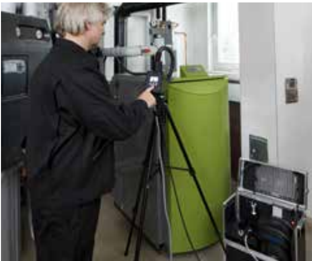
Altezza di lavoro regolabile – direttamente dalla valigia con tubo telescopico oppure mediante uno stativo (opz.).
