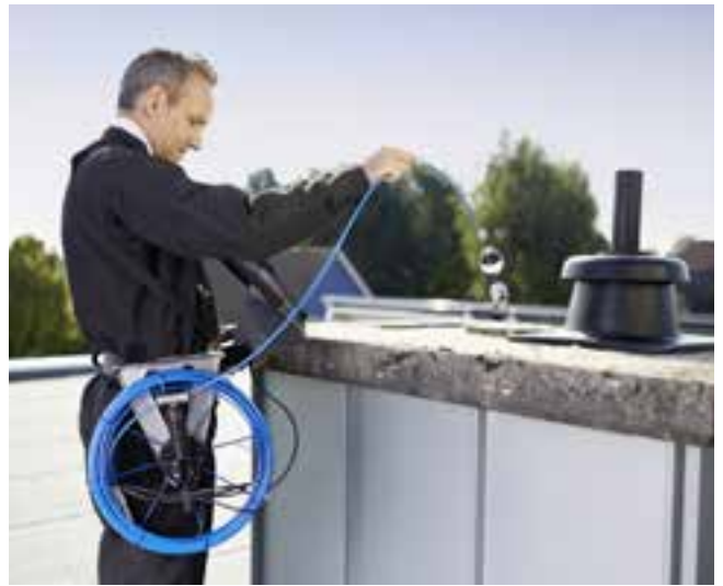
Comoda videoispezione dall'alto con l'aspo e luci supplementari
