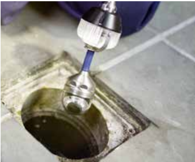
Videoispezione di scarichi fognari
