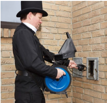
Abb. 8: Kabeltrommelkamera vor dem Körper getragen
