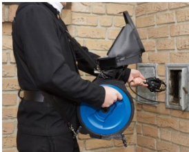
Abb. 13: Kabeltrommelkamera mit Tragegurt getragen
