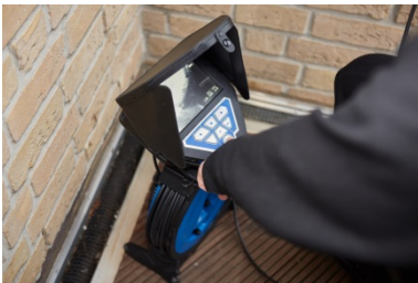
Fig. 9: Telecamera con avvolgicavo posizionata sul pavimento
