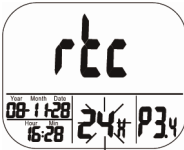
Fig. 15: Choix possible entre un affichage des heures sur 12 heures ou sur 24 heures
