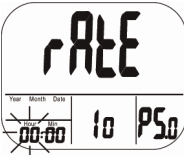
Imm. 3: Impostazione dell'intervallo di misura (ore)
