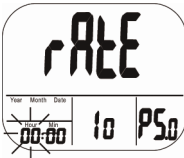
Afb. 17: Instellen van de aftastfrequentie (uren)
