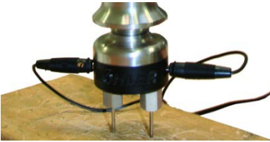
Fig. 20: Collegamento della sonda a percussione
