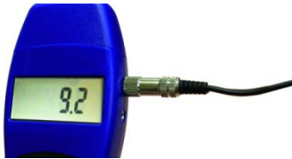
Fig. 21: Collegamento del cavo al Wöhler HBF 420
