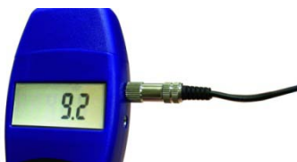
Fig. 10: Connecter le câble au Wöhler HBF 420.
