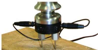
Fig. 9: Connecter le câble a la sonde d'insertion
