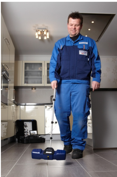
Fig. 41: Localizzazione della testata VIS nel pavimento
