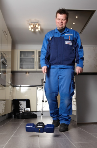
Abb. 6: Lokalisierung des Kamerakopfes im Boden
