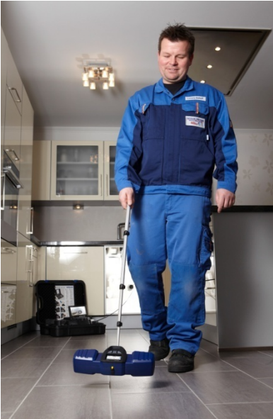
III. 24: Localisation de la tête de caméra dans le sol
