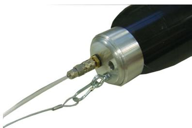
Fig. 73: Collegamento filo d'acciaio
