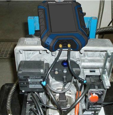
Fig. 9: Wöhler M 603 nella misura di differenza pressione al bruciatore gas
