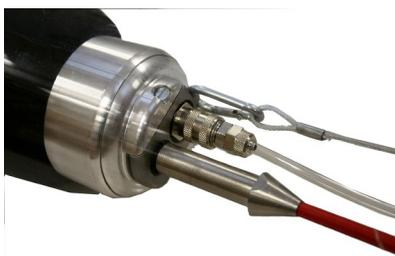
Fig. 71: Staccare la sonda dell'aspo
