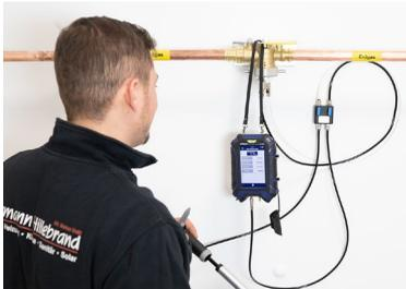
Fig. 21: Prova meccanica con il Wöhler M 603
