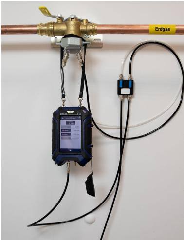
Fig. 25: Collegamento Wöhler M 603 all'impianto gas con set prova tenuta (opz.)
