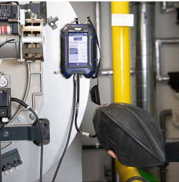
Fig. 5: Wöhler M 603 con serbatoio morbido prova UNI 11137 collegato
