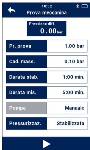
Fig. 12: Display del Wöhler M 603, esempio di pulsanti attivi e inattivi e di visualizzazione dei valori misurati
