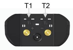
Fig. 11: Piastra sulla base con le prese di temperatura
