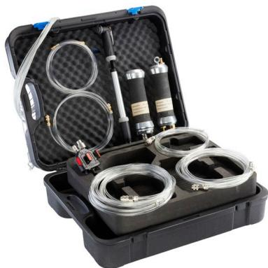
Fig. 65: Accessori per la prova di tenuta
