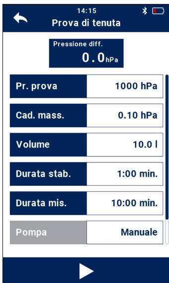
Fig. 26: Prova di tenuta UNI 7129
