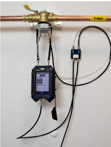
Fig. 29: Collegamento Wöhler M 603 all'impianto gas con set prova tenuta (opz.)
