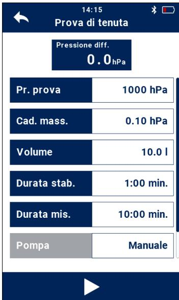
Fig. 30: Prova di tenuta UNI 11528
