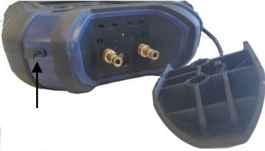
Fig. 4: Cappuccio protettivo con indicazione della presa USB (freccia)
