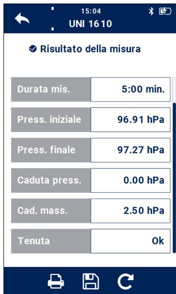
Fig. 77: Risultato della prova UNI 1610
