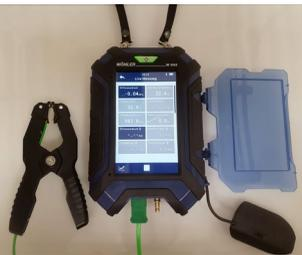
Fig. 10: Collegamento del sensore temperatura a pinza
