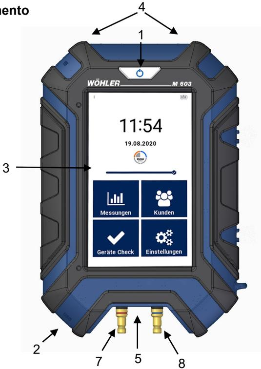
Fig. 2: Wöhler M 603 analizzatore di tenuta
