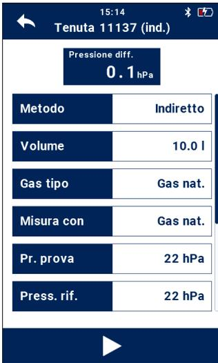
Fig. 41: Prova di tenuta UNI 11137 metodo indiretto
