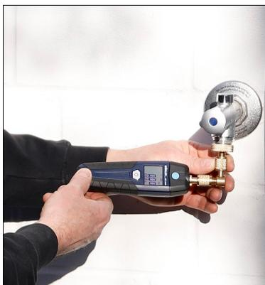
Fig. 61: Collegamento Wöhler SC 660 all'impianto.
