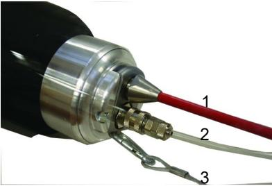
Fig. 67: Soffietto terminale con sonda di spinta dell'aspo (1), tubo di gonfiaggio (2) e cavo d'acciaio (3).
